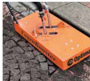
Décharge contrôlée de la matière
